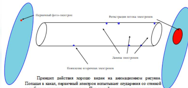
Принцип действия хорошо виден на анимационном рисунке. Попадая в канал, первичный электрон испытывает соударения со стеной и выбивает вторичные электроны. Под воздействием электрического поля этот процесс многократно повторяется, позволяя получить коэффициент усиления в тысячи раз.
